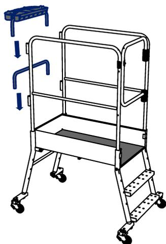
**E** Assembler la tablette et la lisser sur les garde-corps. Ces 2 éléments peuvent être inversés si besoin.
