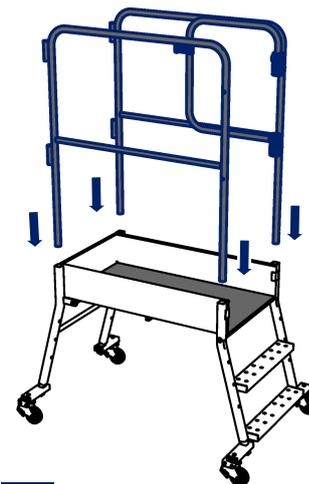
**D** Insérer les garde-corps dans les montants des piétements. Le garde-corps avec portillon se positionne à droite, côté montée.
