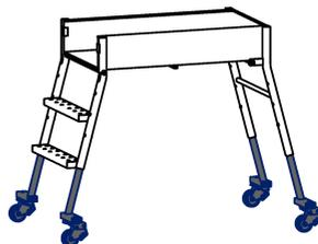
**A** Ouvrir les piétements de support et de montée jusqu'en butée.
